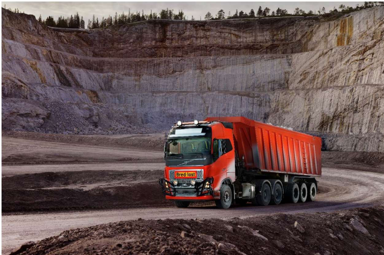
Uttesting av Volvos autonome lastebil utviklet for Brønnøy Kalk. Uttestingen skjer i tråd med tillatelse fra Statens vegvesen. © Volvo Truck Corporation, alle rettigheter.
